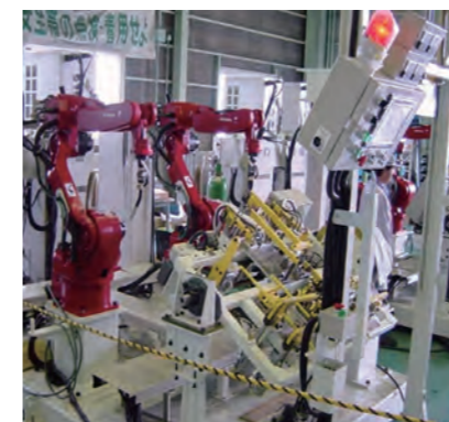
ロボットシステム導入(自動車産業：溶接)
